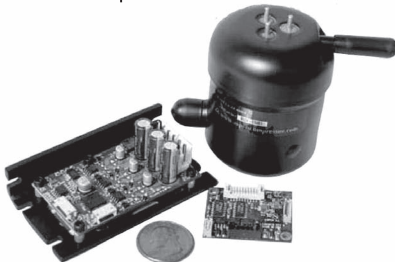
Figura 1. Mini compressore con scheda di controllo.
